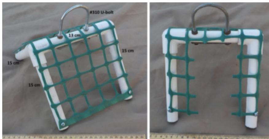
Рис. 3. Новая (слева) и поврежденная крышка (справа). Трубка 20 мм.
