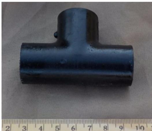
Рис. 4. Раствор (изготавливается из 20 мм тройника)
