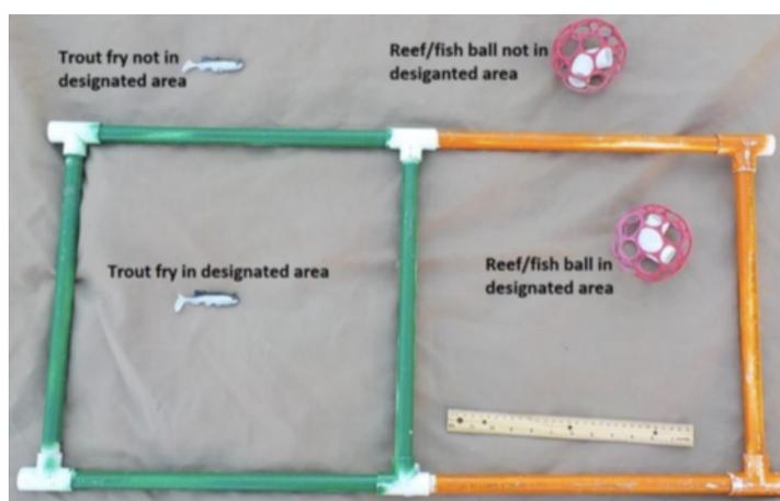
Рис. 10. Пример установки мальков и рифов в заданной области и вне области. Размер ячейки 40x40 см. Изготовлена из 20 мм трубок.
