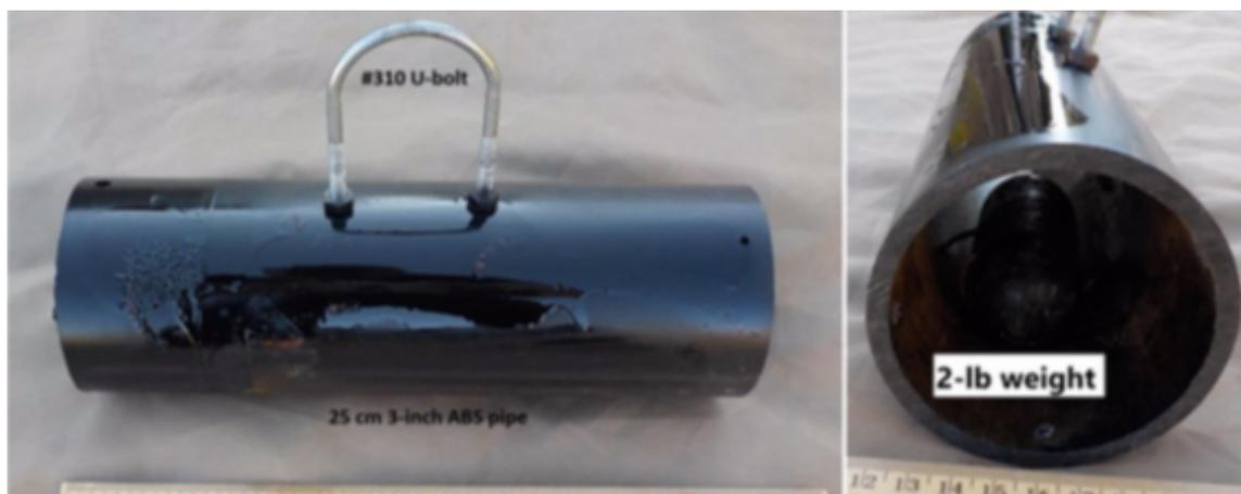
Рис. 12. Пушка. Вес пушки приблизительно 0,9 кг. Внешний диаметр – 9 см, длина – 25 см.
