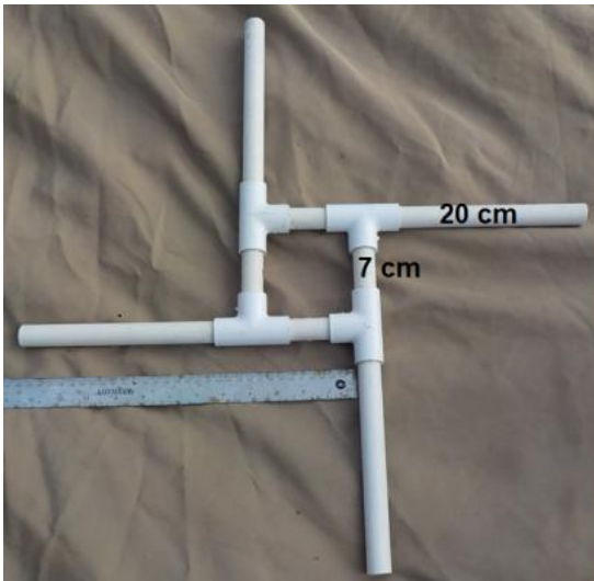
Рис. 2. Размеры коннектора (изготавливается из 20 мм труб)
